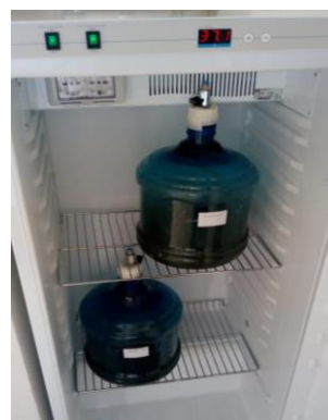
Figura 4. dos digestores en termorrefrigerador.
