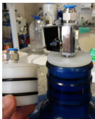
Figura 3. tapa de plástico duro fabricada a medida con doble sello y rosca para conector.
