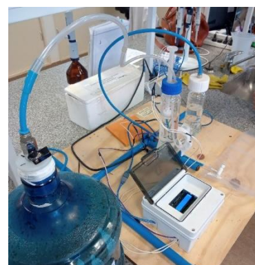
Figura 8. caudalímetro automatizado con registro de datos midiendo biogás.
