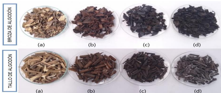
Figura 2. Proceso de Torrefacción de broza y tallo de algodón a las temperaturas: (a) 25°C, (b) 200°C, (c) 250°C y (d) 300°C.
