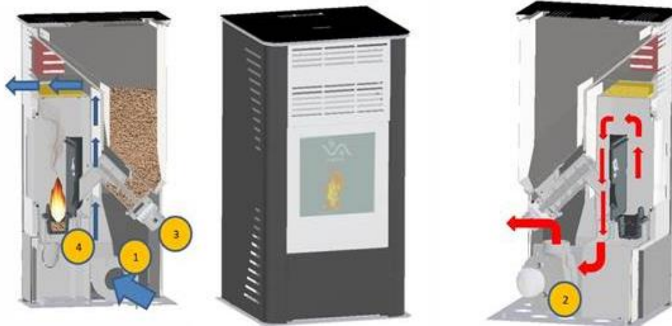
Figura 4. Diseño 3D 1) Entrada de aire, 2) Sal. de humos, 3) Tolva de carga de combustible, 4) Cámara de combustión. Fuente: [Productos Verayre]
