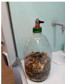
Figura 1. primer diseño de biodigestor y recipientes para medición de caudal.
