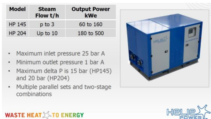
Figura 7.35. Modelos de expansores de tornillo de la HELIEX y sus parámetros (Juan DeBlas JuanD@heliexpower.com , comunicación personal).
