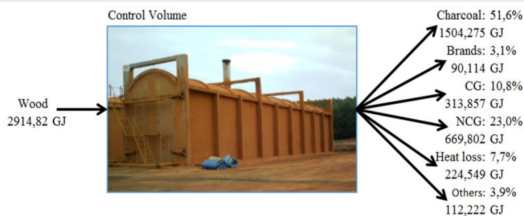
Figura 7.49. Balance de energía de un horno batch típico (Leme et. A., 2018).
