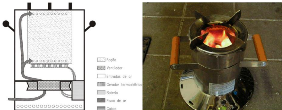
Figura 7.45. Fogón de leña de la Philips con placas termoeléctricas para el accionamiento de un ventilador ( http://www.cyto.purdue.edu/cdroms/gh/HTML/start.htm?loc=http://www.cyto.purdue.edu/cdroms/gh/HTML/program/Woodstove.html ).
